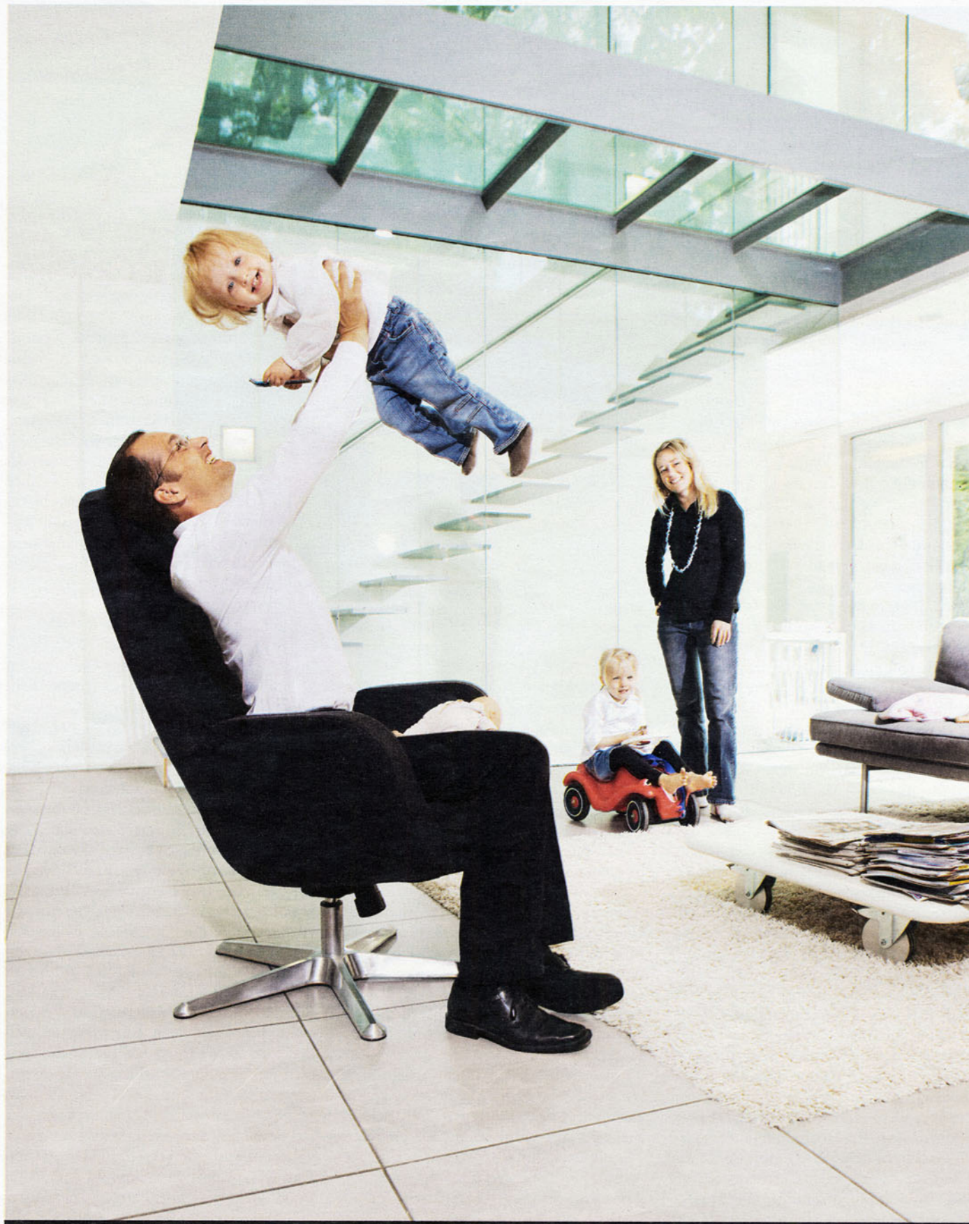
Luxuriös, aber ökologisch wertvoll: Architekt Holger Gravius hat seiner Familie in Essen ein sehenswertes Heim gebaut. Große Glasflächen etwa sammeln Energie, die dann in den gefliesten Böden gespeichert wird. Im Sommer wird die Hitze durch das offene Treppenhaus und den Kamineffekt zum Dach hinaus transportiert.
